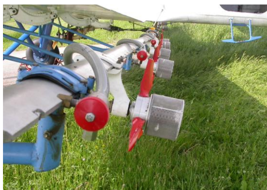
Atomizery typu Micronair AU 5000 zamontowane na samolocie ( fot. B. Głowacka )
