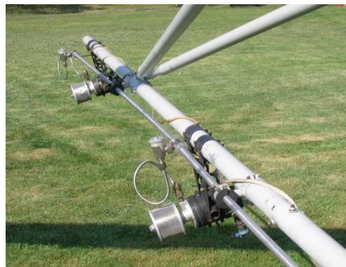
Atomizery elektryczne AR 470.04 zamontowane na śmigłowcu ( fot. B. Głowacka )
